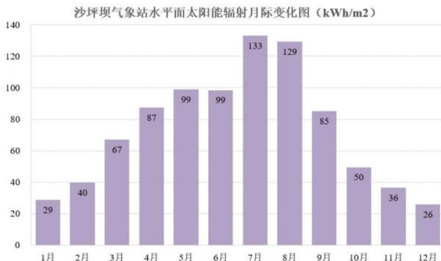
图 2.2-3 沙坪坝气象站逐月平均辐射量月际变化图(kWh/m<sup>2</sup>)表 2.2-1 沙坪坝气象站逐月平均辐射量月际变化图表(kWh/m<sup>2</sup>)
